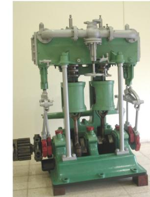
Motor de vapor de dos cilindros
